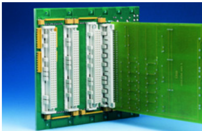
Codierleisten FL montiert auf einer Rückwandplatine
